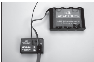
Nitro - le récepteur utilise un pack récepteur pour l'alimentation.
