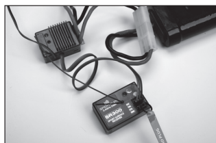
Électrique - le récepteur utilise le contrôleur électronique de vitesse pour l'alimentation.
