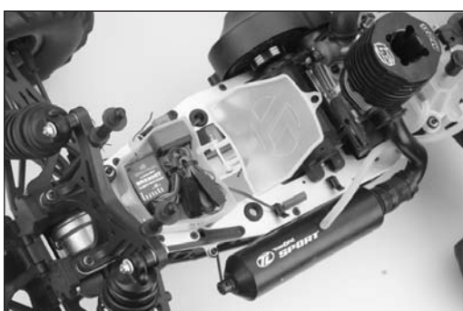
Installation typique pour véhicule à essence
